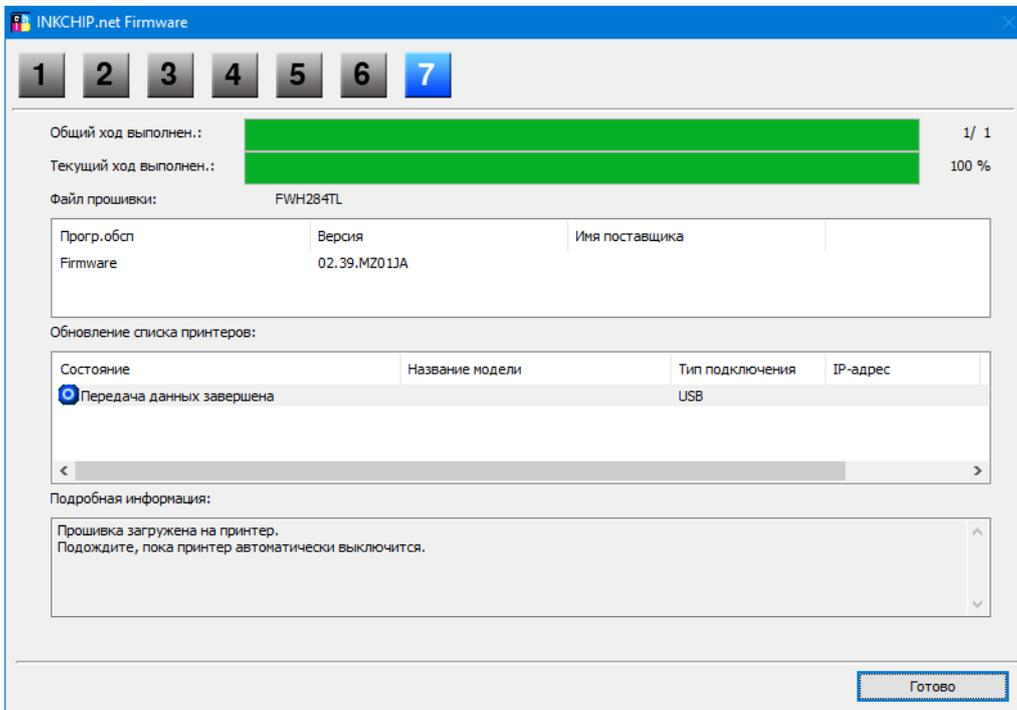
На этом этапе безчиповая прошивка будет загружена в принтер. О завершении процесса загрузки прошивки в принтер будет свидетельствовать надпись «FINISHED» на дисплее принтера. После этого нажмите кнопку «НАЗАД» на панели управления и принтер выключится.
