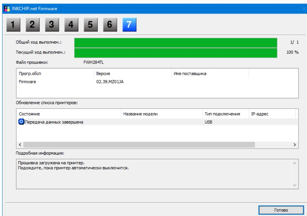
На этом этапе безчиповая прошивка будет загружена в принтер. О завершении процесса загрузки прошивки в принтер будет свидетельствовать надпись «FINISHED» на дисплее принтера. После этого нажмите на середину сенсорной панели и принтер выключится.
